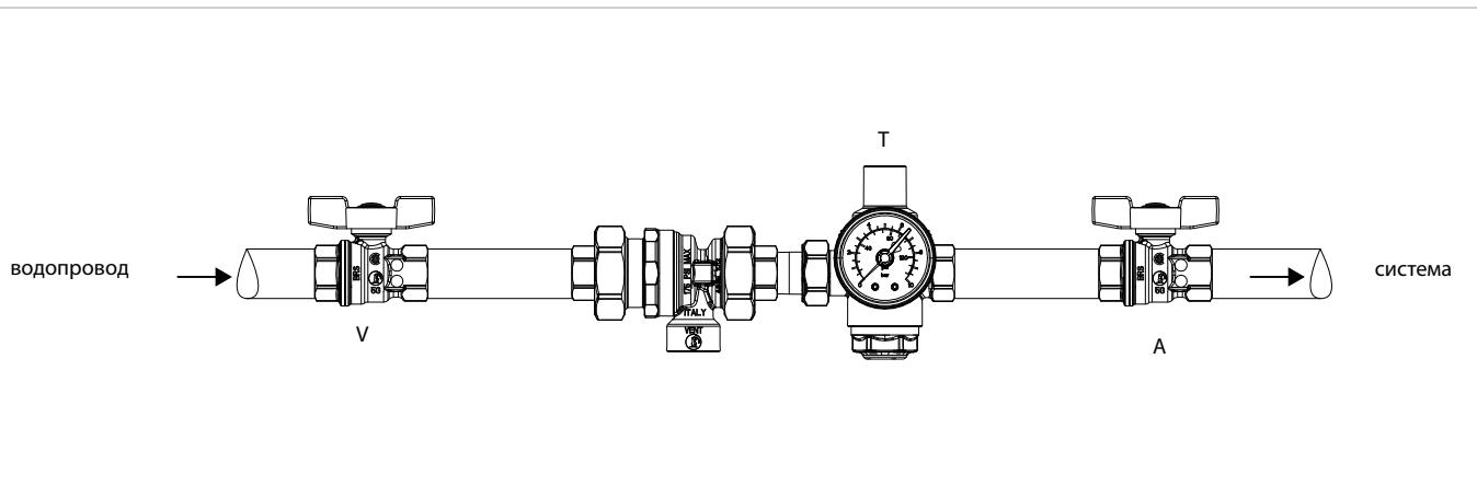
Для корректной настройки давления после наполняющего клапана необходимо установить запорный кран. Согласно выше приведённой схемы осуществить настройку клапана наполнения следуя информационному листку.
