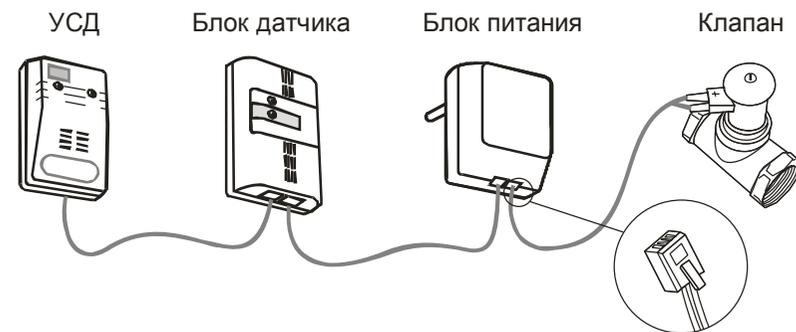
Рисунок 1 – Схема соединений сигнализатора СИКЗ двухблочного исполнения
