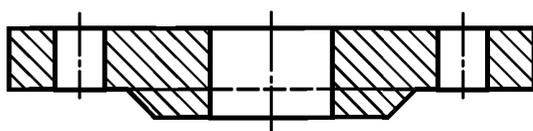
Примечание – Штрихпунктирная линия – для уплотнительной поверхности исполнения А (для *PN 1*, *PN 2,5* и *PN6*)
