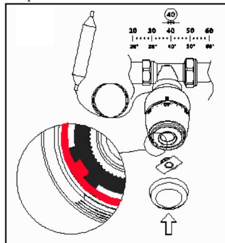
6.4. После указанных манипуляций следует установить на место фиксирующую планку «с» (до щелчка) и надеть крышку корпуса «b».
