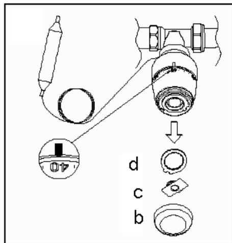
6.2. Для ограничения регулировки следует установить верхнее стопорное кольцо таким образом, чтобы крайний левый «зуб» кольца находился справа от «зуба» корпуса и соприкасался с ним. В таком положении регулировка термоголовки будет возможна в интервале от +20°C до настроечного значения.
